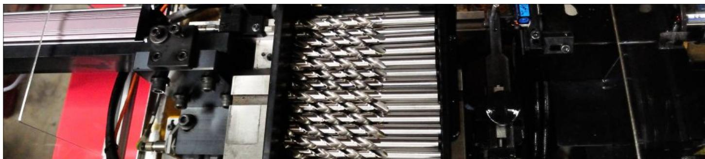
Foret HSS taillé meulé STEAM pour le perçage rapide et endurant des aciers et des aluminiums. Perçage aisé grâce à son substrat HSS et son affûtage autocentrant pointe en croix.
